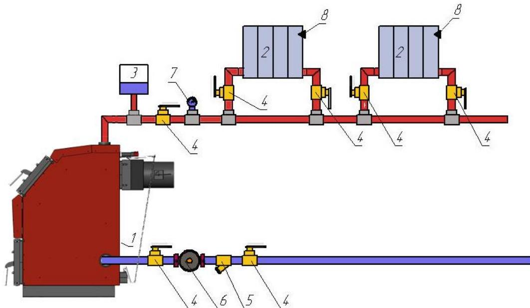
**Рис. 7 Схема подключения котла к однотрубной открытой системе с принудительной циркуляцией теплоносителя**
