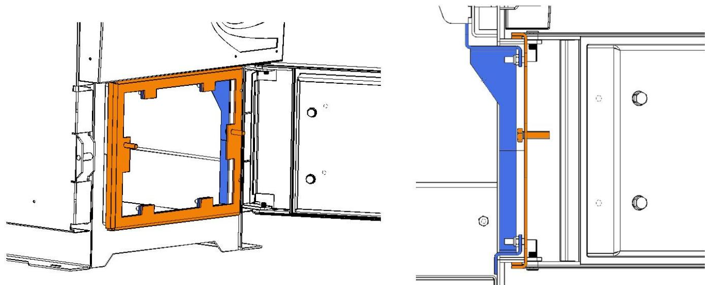
**Рис. 13 Установка передней панели монтажной рамки**
