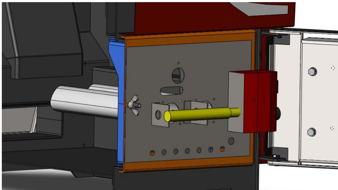
Рис. 14 Установка газовой горелки
