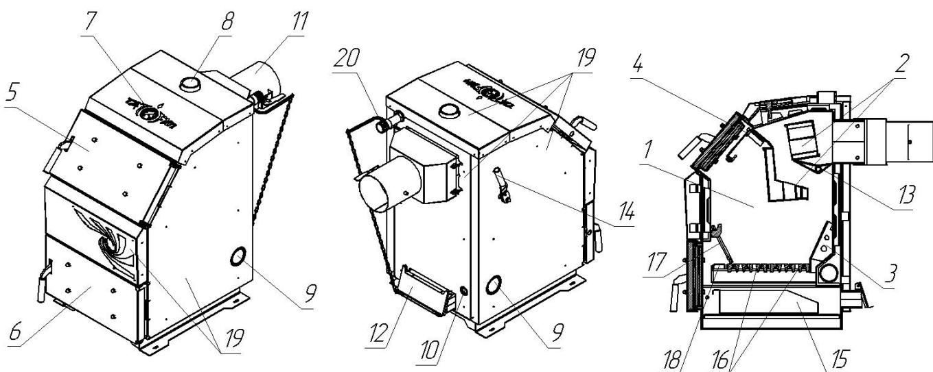
**Рис. 2 Устройство котла TAIFUN 16кВт**
