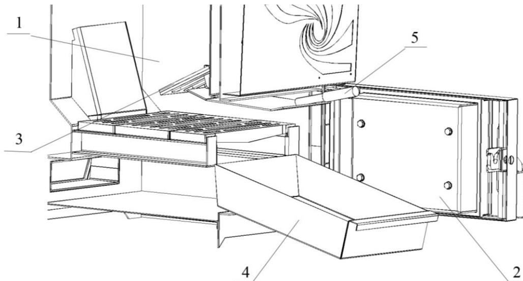
**Рис. 10 Удаление спекшегося шлака**
