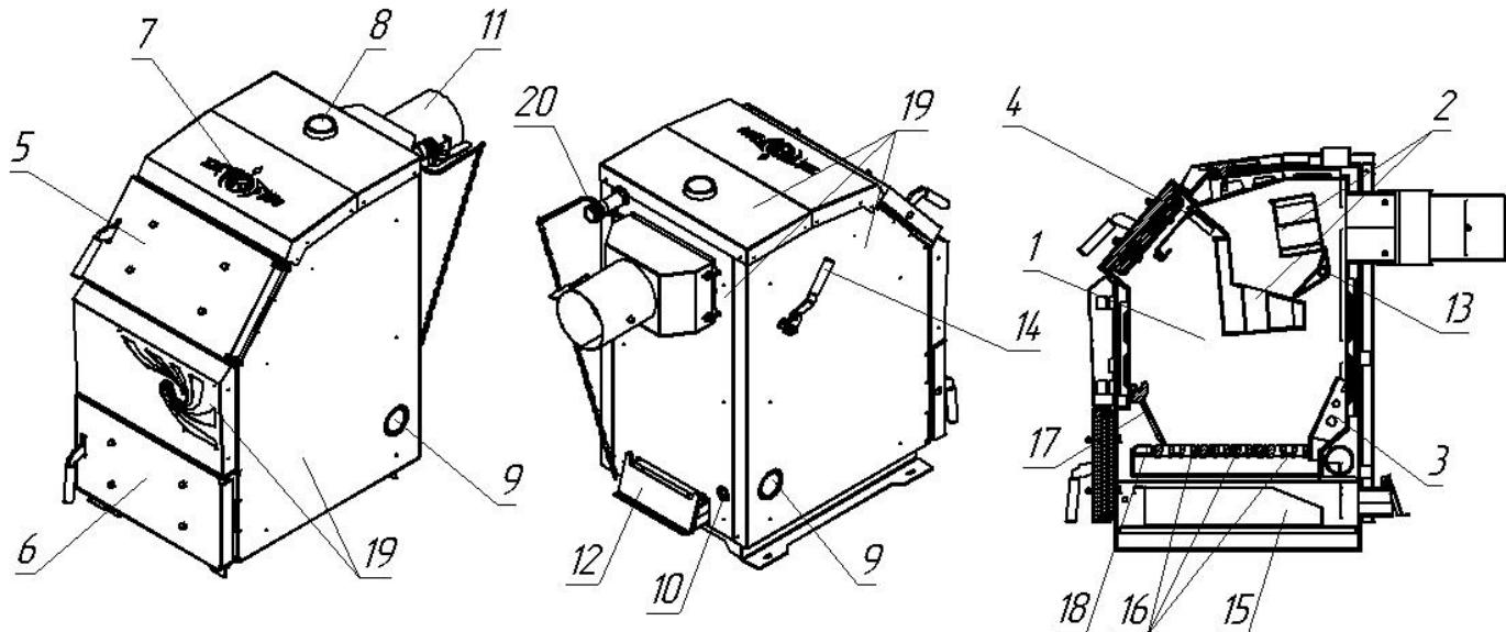
**Рис. 3 Устройство котла TAIFUN 20кВт**
