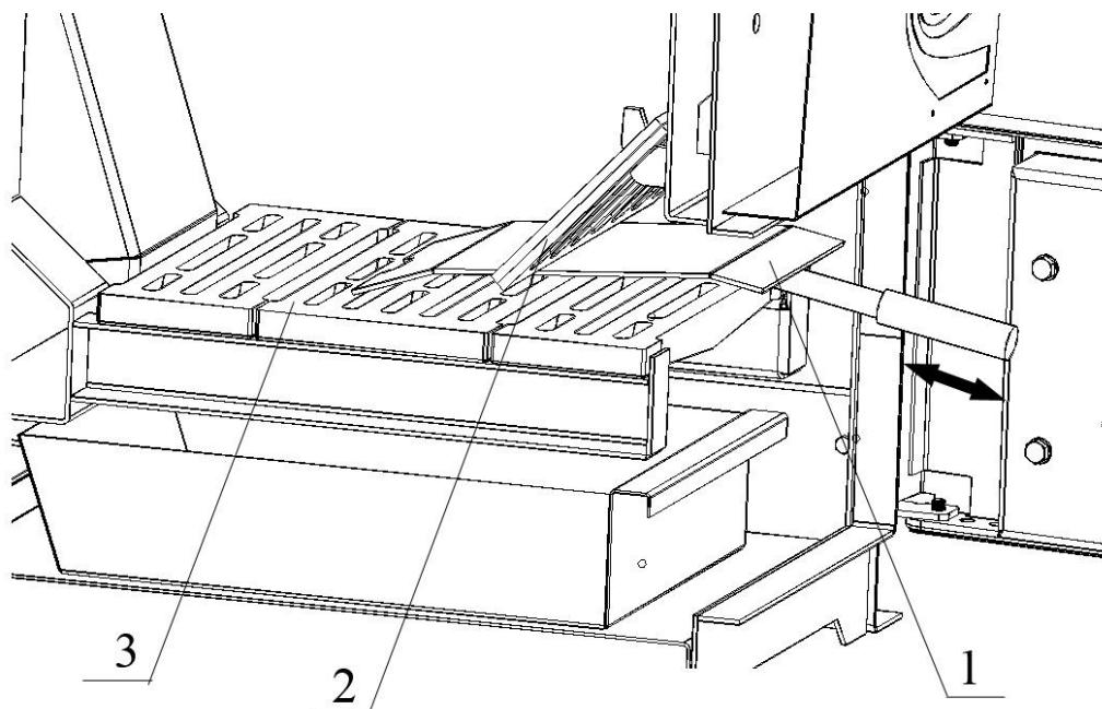
**Рис. 11 Подрезание шлака**
