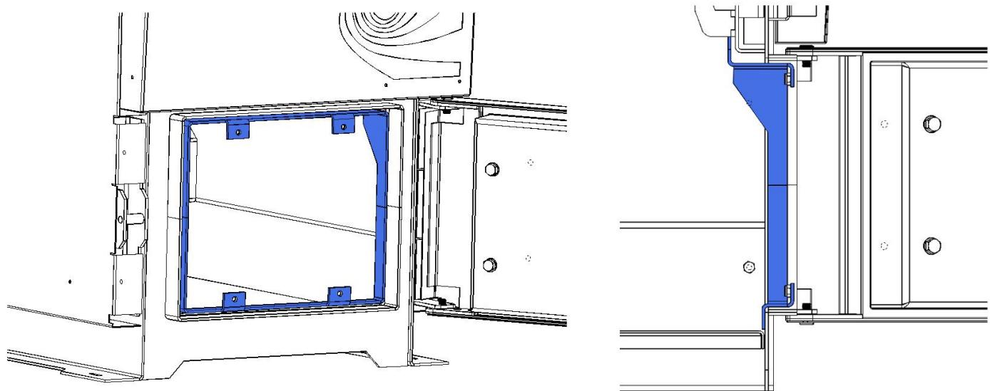
**Рис. 12 Установка внутренней части монтажной рамки**
