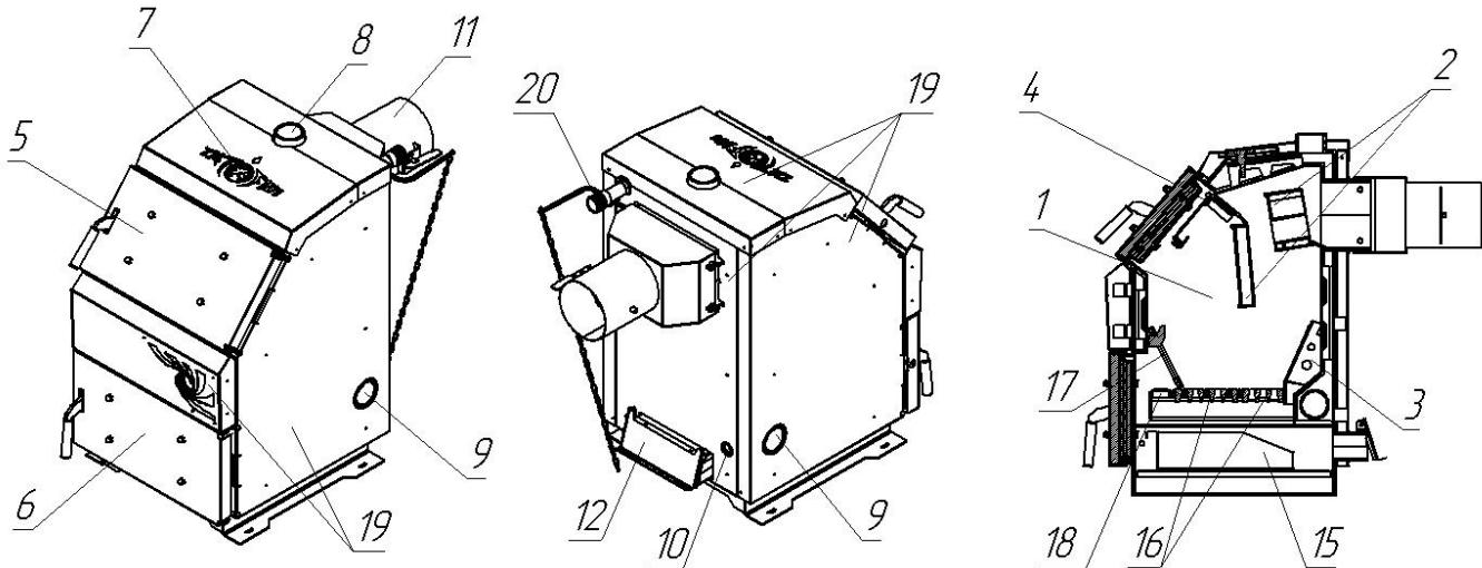
**Рис. 1 Устройство котла TAIFUN 12кВт**
